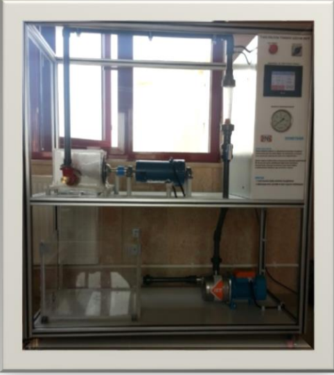
Pelton Türbini Deney Düzeneği
