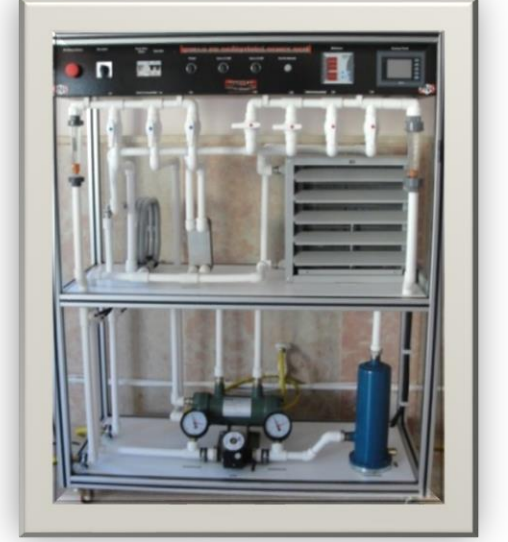
Çoklu Isı Değiştirici Deney Düzeneği
